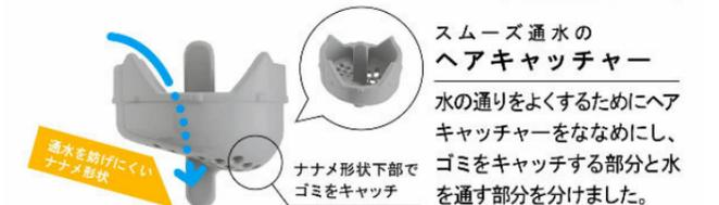
スムーズ通水のヘアキャッチャー。水の通りをよくするためにヘアキャッチャーをななめにし、ゴミをキャッチする部分と水を通す部分を分けました。
